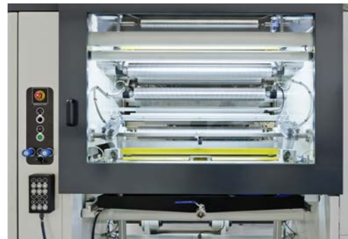
Blick in die neue, eigens für den Digitaldruck installierte Kaschieranlage im Digital-Center bei O. Kleiner in Wohlen.
